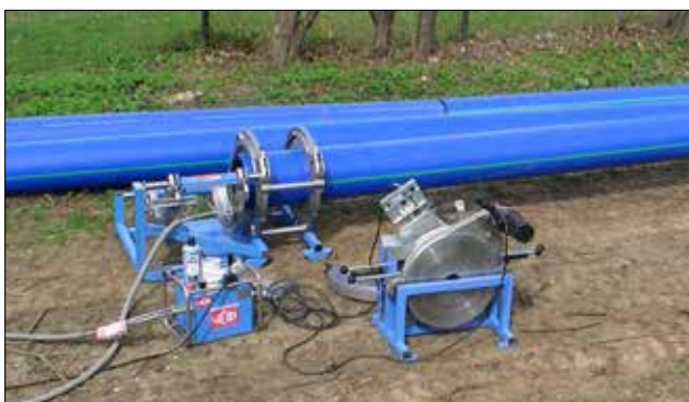
5.30 Serviceleistung von Gerodur: projektbezogene Beistellung von Spannbacken für Heizelement-Stumpfschweißung (Widos) – Lieferung in robuster Baustellen-Box
