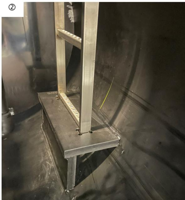
Die Einstiegshalterung wird, bei Bedarf ausgezogen und auf der obersten Sprosse, für einen sicheren Einstieg, fixiert ③
