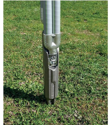
**5** Standard-Gussgewicht am Sondenfuss montiert
