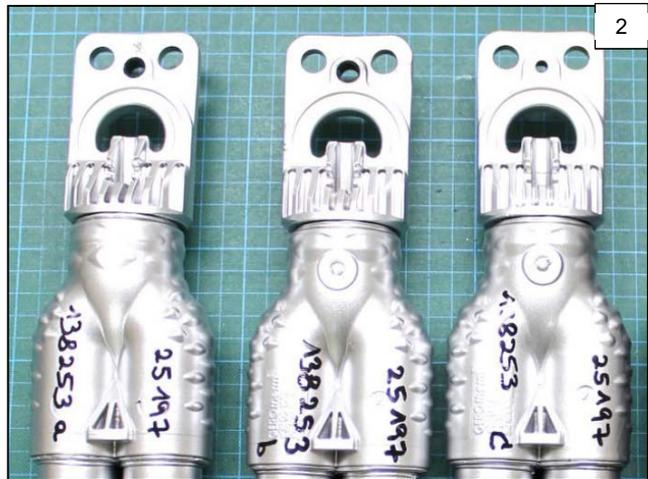
Bild 2: EWS-Umlenkung mit Barrierebeschichtung
